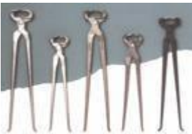
Tenazas de forja: Utilizadas para agarrar objetos Candentes.
